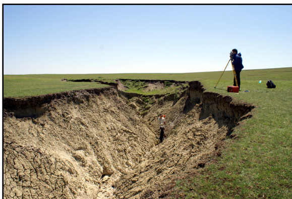
Fig. 4. Echipamentul Stației totale Leica TC 407 folosit pentru ridicarea topografică a Ravenei Gurguiata Mică (2 – 6 iunie 2008).
